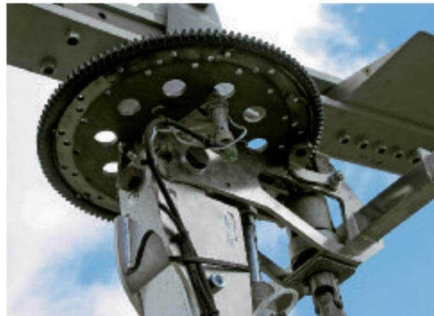
Ins Zahnrad unter dem Rotor greift das Ritzel zum Vorrätieren beim Start ein
