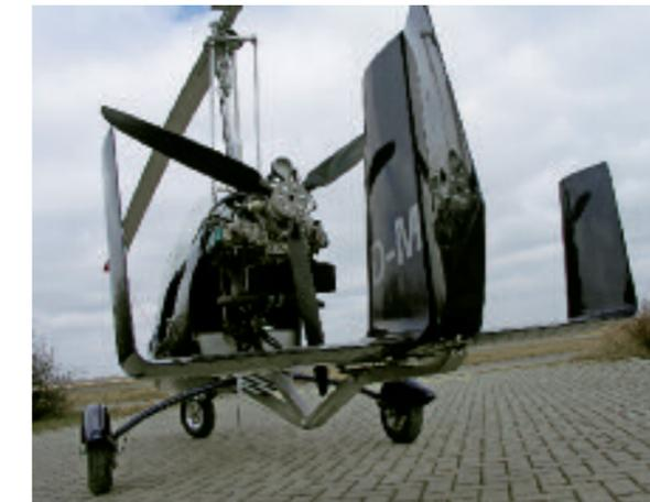
Das große Seitenruder beim MT-03 erfüllt die gleiche Funktion wie der Heckrotor beim Helikopter
