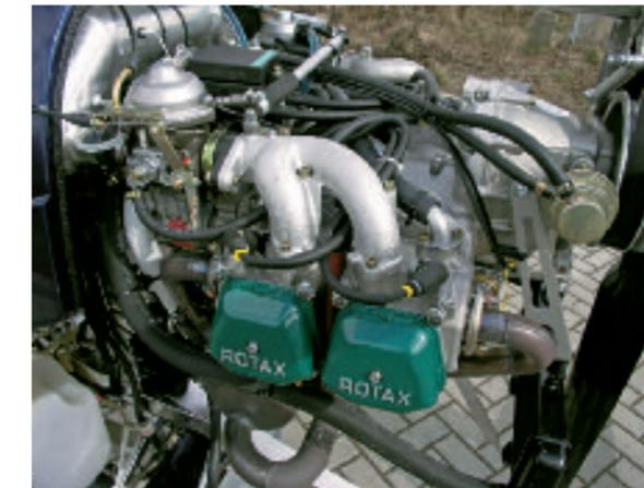
Kraftquelle: Entweder der hier eingebaute Rotax 912 UL S mit 100 oder ein 914 Turbo mit 115 PS treibt den Druckpropeller an
